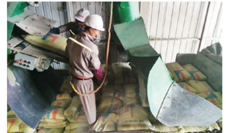
华润水泥加大粉尘治理力度，在广西田阳、福建曹溪、贵州金沙等项目配置移动收尘系统，有效降低了包装和装车环节粉尘浓度，图为水泥装车移动收尘系统
