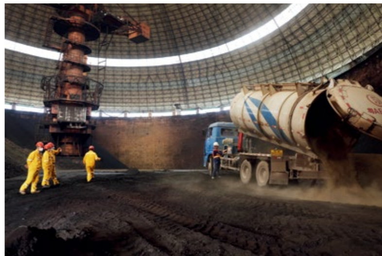
广州华润热电厂开展城市污泥无害化处置，打造绿色煤电
